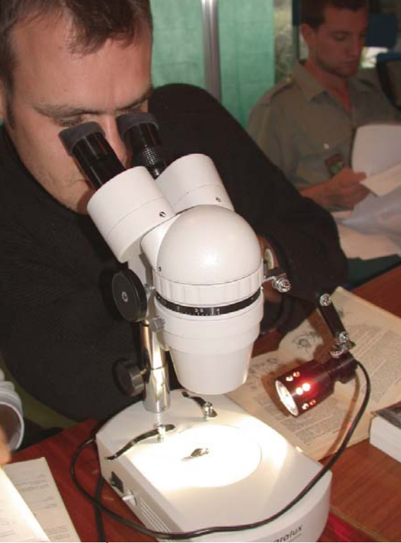
La loupe binoculaire statique est un outil indispensable à la systématique des invertébrés. Cliché H. Guyot
