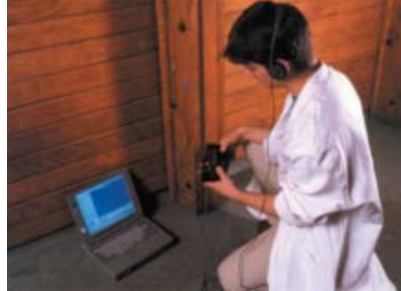
Détection des termites par INADEC Cliché CTBA
