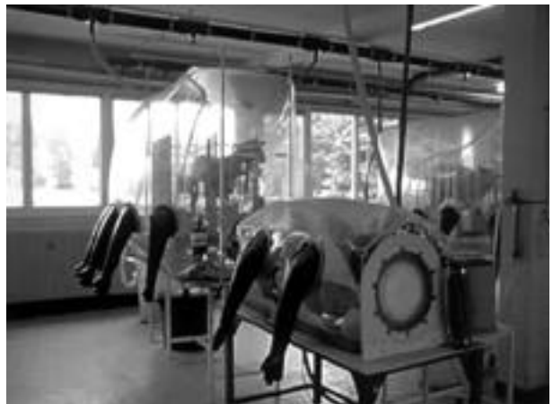
Isolateurs (deuxième génération) pour agneau à fiores partiellement contrôlées. Devant : isolateur de stockage du matériel et des aliments. Au fond : isolateur d'élevage. A droite : sas d'entrée liquide. Photo communiquée par P. Gouet.
